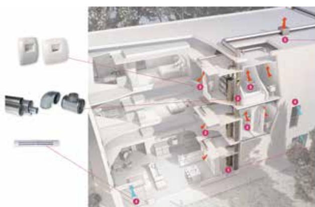
Principe de fonctionnement de la solution T.Flow® Hygro+ / Nano en Logement Collectif
