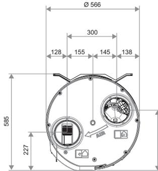
Encombrement T.Flow® Nano - Raccordement aéraulique
