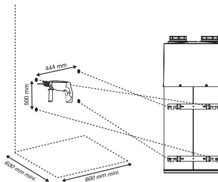
Installation de T.Flow® Nano - Installation au mur
