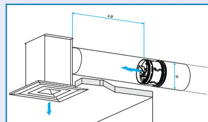
2/ MR installé en amont d'une bouche de type BIM
