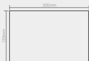
DIMENSIONS DE LA DECOUPE DE LA PLINTHE
